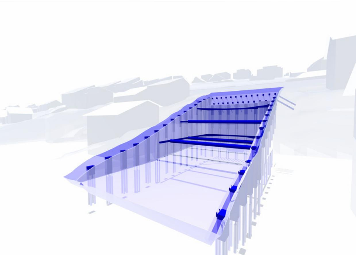
3D-Modell Baugrubensicherung, Neubau EFH MFH Obermoos, Boll
